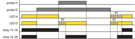
PUMP DOWN, OFF DELAY (Function 6)
